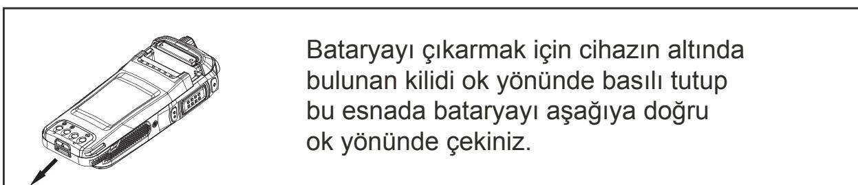
Bataryayı çıkarmak için cihazın altında bulunan kilidi ok yönünde basılı tutup bu esnada bataryayı aşağıya doğru ok yönünde çekiniz.
