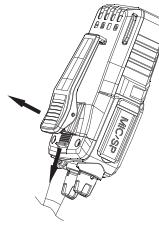
Bataryayı çıkarmak için cihazın altında bulunan kilidi ok yönünde basılı tutup bu esnada bataryayı geriye doğru ok yönünün tersine çekiniz.
