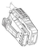
Bataryayı cihazın üst kısmındaki yatağa oturacak şekilde tutup alt kısmının sesi duyuluncaya kadar cihaza doğru itiniz. Batarya kilitlenecektir.
