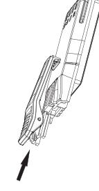
Kemer askisını telsizin sırt kısmındaki yuva üzerine oturtup ok işaretinin yönünde aşağı doğru kaydırınız. Çıkmak için kemer askisının kilidini yukarı çekip ters yönde itiniz.
